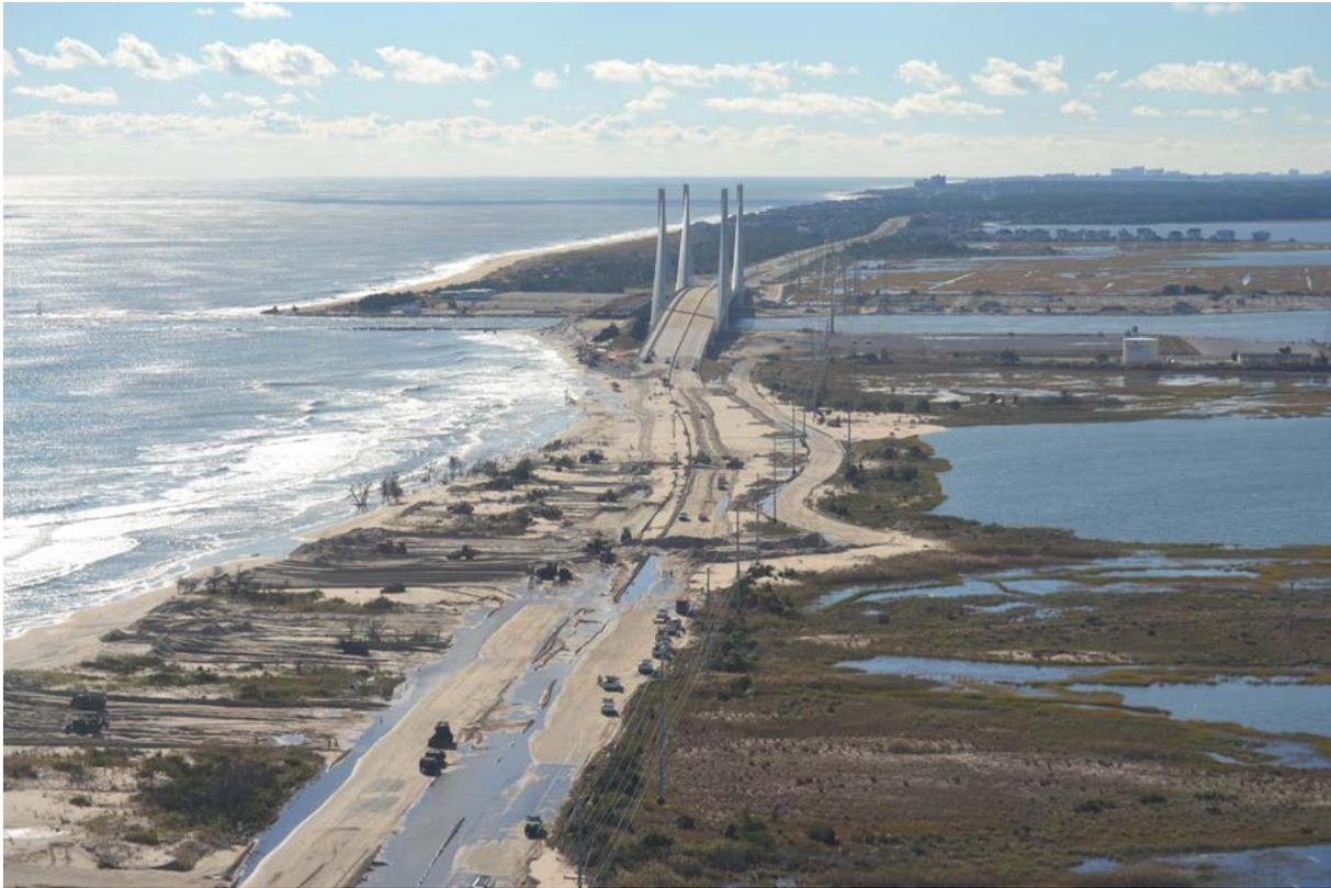
La ruta 1 en la Indian River Inlet estaba intransitable después de la super tormenta Sandy debido a la importante erosión de las dunas. Se prevé que los fenómenos meteorológicos extremos, junto con los daños por tormentas más costosos, se volverán más frecuentes como resultado del cambio climático. Fotografía: DNREC
